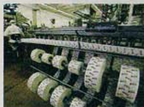
Glosspapper på rulle. Allting är helt automatiserat. Maskinen viker, skär och limmar ihop omslagspappret kring glassen.
