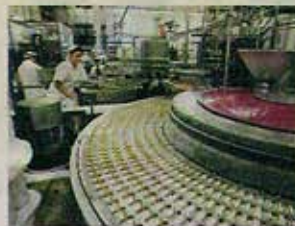
Glassmixen hålls i formar i en stor roterande trumma. Under trumman varv fryses glassen, förses med pinne och slutligen omslagspapper.
